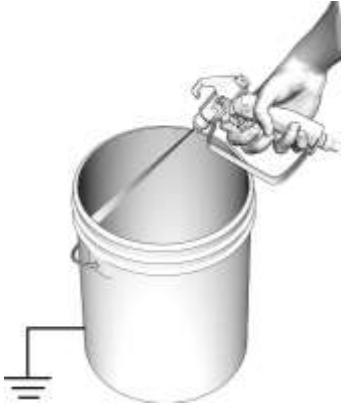
Закройте Кран сброса давления ЛКМ из фильтра 10 (см. стр. 8). На распылительном пистолете снимите блокировку курка (см. стр. 11). Плотно прижмите металлическую часть пистолета к заземленному металлическому ведру. Нажмите на курок пистолета. Увеличивайте давление воздуха с помощью Регулятора давления 11 (см. стр. 8) до запуска насоса. Используйте минимально возможное давление. Осуществляйте промывку до полной очистки.
