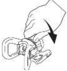
Установите соплодержатель с соплом на пистолет. Затяните.
