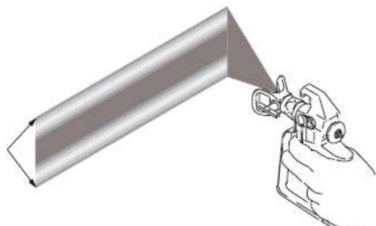
Выполните пробное распыление. Отрегулируйте давление насоса с помощью Регулятора давления 11 (см. стр. 8), чтобы устранить излишки краски на кромках. Используйте сопло меньшего размера, если с помощью регулировки давления не удается устранить излишки краски на кромках.
