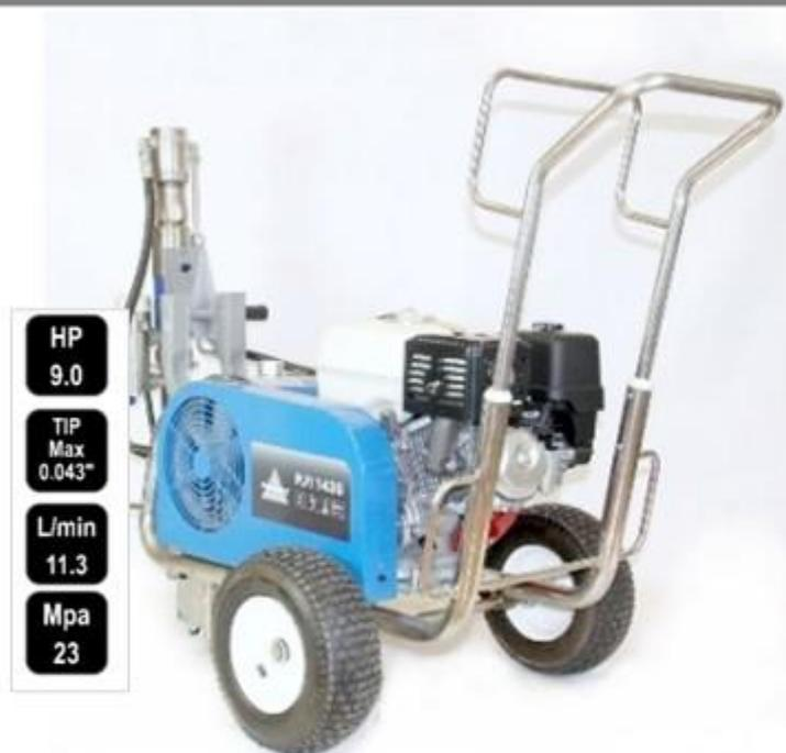
Высокопроизводительный гидропоршневой окрасочный аппарат производительность 11,0 л/мин для безвоздушного распыления с бензиновым двигателем Honda мощностью 9 л.с. Способен распылять большинство лакокрасочных материалов с одновременным подключением нескольких краскопультов, но чаще применяется при нанесении высоковязких и наполненных составов таких, как мастики, огнезащитные краски, цинконаполненные материалы и прочие антикоррозийные составы с высоким сухим остатком.
