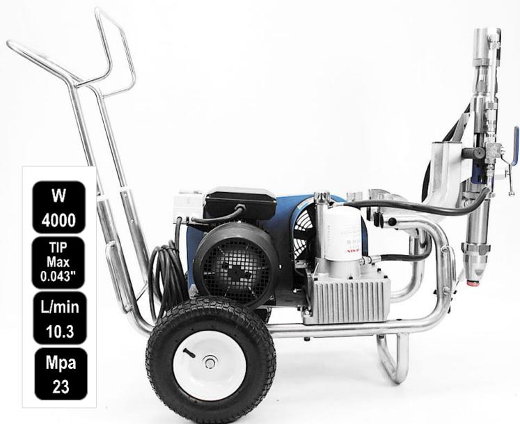
Безвоздушный окрасочный аппарат с электрическим приводом и пневматическим насосом мощностью 4000 ват, расход материала 10.3 литров в минуту. Максимальный размер сопла - 0,043 Дюйм. Гидропоршневой аппарат предназначен для ЛКМ **высокой** вязкости с содержанием абразивов для грунтования и окраса больших объемов в промышленности и на производстве, для нанесения полимерной шпатлёвки, огнезащитных и двух компонентных составов с одновременным применением двух краскораспылителей
