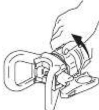
Снимите соплодержатель с соплом с пистолета.
