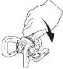
Установите соплодержатель с соплом на пистолет. Затяните.
