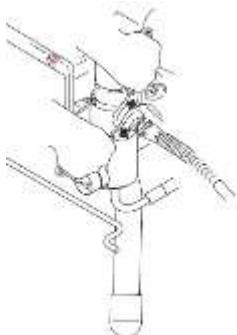
Подсоедините безвоздушный шланг к выпускному отверстию для материала. Надежно затяните с помощью гаечных ключей.
