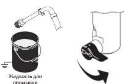
Поднимите шланг забора выше уровня жидкости для промывки. Поверните клапан 9 (см. стр. 10) в горизонтальное положение. Переместите пистолет в емкость для промывки, прижмите его к емкости и нажмите на курок, чтобы полностью очистить шланг и насос от жидкости. Установите блокировку курка.
