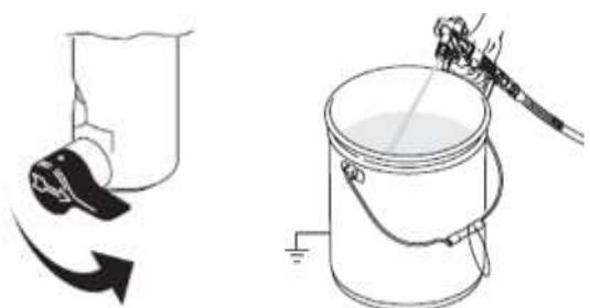
Поверните клапан 9 (см. стр. 10) в горизонтальное положение. На распылительном пистолете снимите блокировку курка (см. стр. 13). Плотно прижмите металлическую часть пистолета к заземленному металлическому ведру для отходов.
