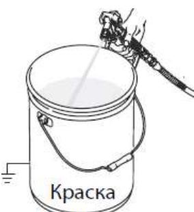
Прижмите пистолет к емкости для краски. Снимите блокировку курка. Нажмите на курок и повышайте давление насоса с помощью регулятора давления 5 (см. стр. 10), пока насос не станет работать устойчиво и из пистолета не появится жидкость для промывки.
