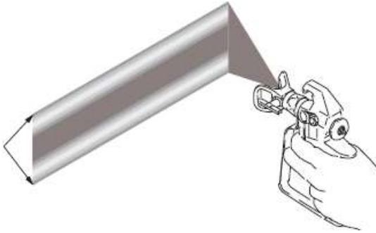
Выполните пробное распыление. Отрегулируйте давление насоса с помощью регулятора давления 2 (см. стр. 10), чтобы устранить излишки краски на кромках. Используйте сопло меньшего размера, если с помощью регулировки давления не удастся устранить излишки краски на кромках.
