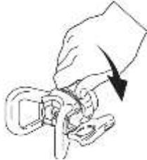
Установите соплодержатель с соплом на пистолет. Затяните.
