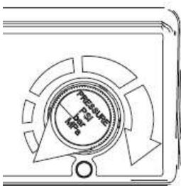
Увеличивайте давление насоса с помощью регулятора давления 2 (см. стр. 10) до запуска двигателя. Краска должна циркулировать по каналам распылителя до тех пор, пока она не появится из сливного шланга.
